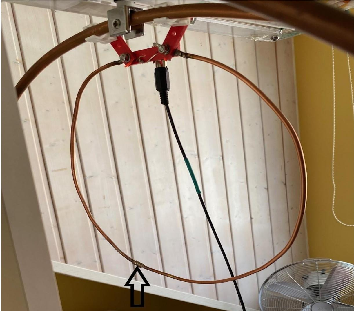
Es ist auch möglich, so die Sendeleistung in die Loop einzuspeisen. Diese Koppelschleife ist mit 4mm Weichkupferrohr gefertigt, man sieht auch, wo die Größe durch Herausschneiden und wieder Zusammenlöten verändert wurde.
